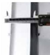
Parede com isolamento de 80 mm
